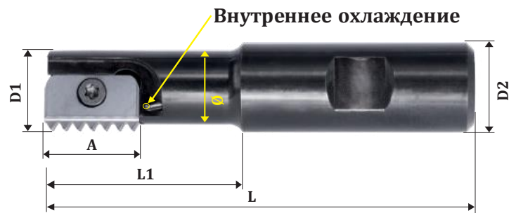
Державка с одним гнездом под пластину
