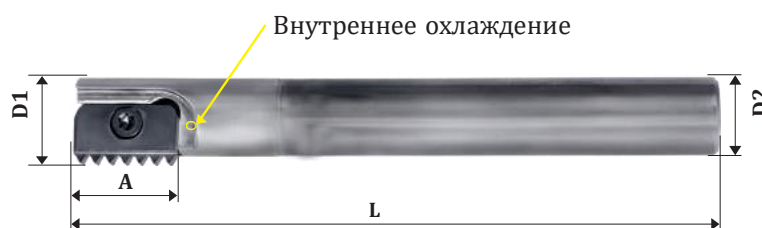
Цельнотвердосплавная державка, длинное исполнение
